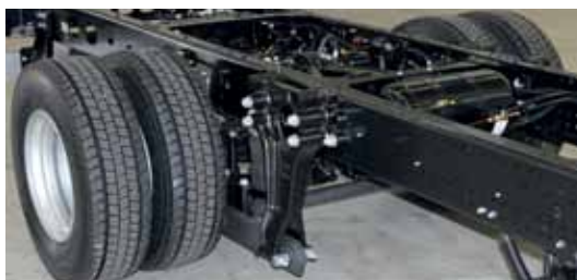
Nové lehčí podpěry, nový design vzduchových měchů.
